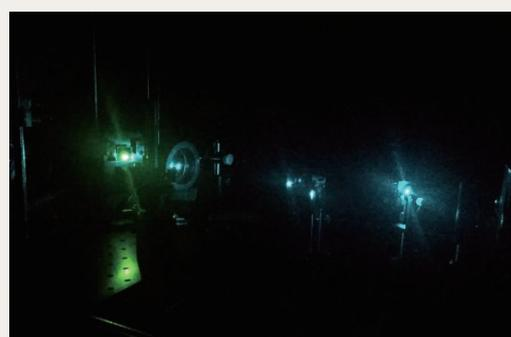
图2：工作条件下的室温连续激发准二维钙钛矿激光器（蓝色为光泵浦源488nm固体激光器光路，绿色为钙钛矿激光器及激光）
