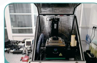
资产名称：散射型近场光学成像及纳米傅里叶红外光谱仪
