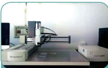
资产名称：高精度微米材料沉积及扫描式激光分析系统
