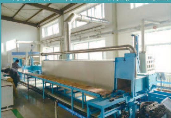
以中国科学院长春应用化学研究所核心技术为依托的世界首条稀土硫化物着色剂连续化隧道窑生产线，日前在中国科学院包头稀土研发中心建成，并实现首批产品下线，标志着中国科学院在稀土高附加值下游应用领域实现了又一次的原创性突破。
