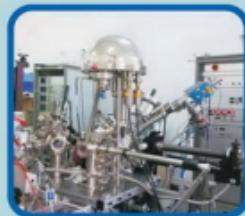
X射线光电子能谱仪
