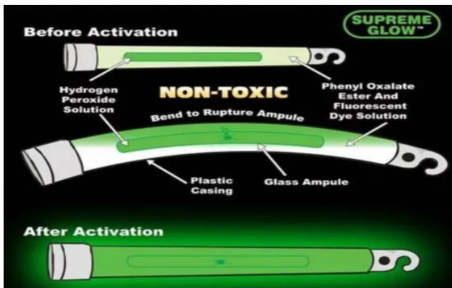
①【图2】荧光棒内部结构（图片来源于腾讯网）
