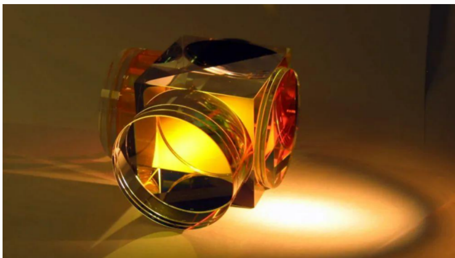
❶【图 5】利用光胶生产的 35mm 宽的迈克尔逊干涉仪（图片来源于知乎）
