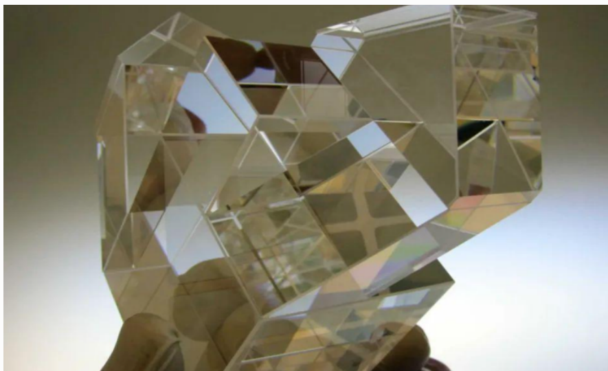
❶【图4】利用光胶生产的单片消色差零位干涉日冕仪,可以直接探测附近的类木星系外行星(图片来源于知乎)
